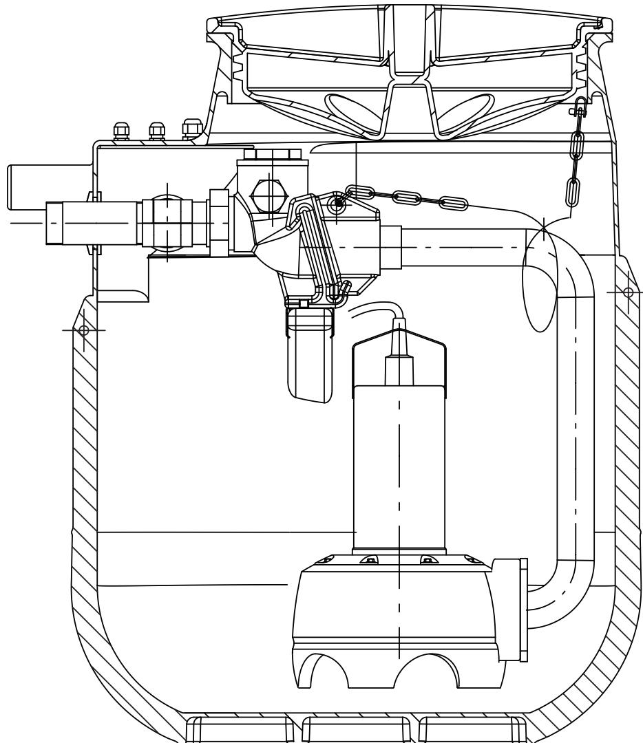
**Монтажные чертежи: Wilo-DrainLift WS 40-50****Установочный чертеж Wilo-DrainLift WS 40****Напольный монтаж**
