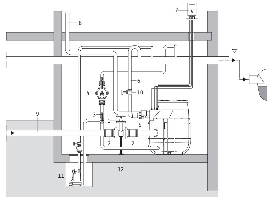
**Монтажные чертежи: Wilo-DrainLift WS 40-50****Установочный чертеж Wilo-DrainLift WS 40****Монтаж под полом**
